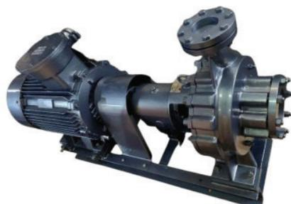
**BB6 - NK (НК), NKV (НКВ), LC (ОН 1/2) Насосы консольные для: нефти и нефтепродуктов, химических жидкостей, сточных вод и суспензий**
